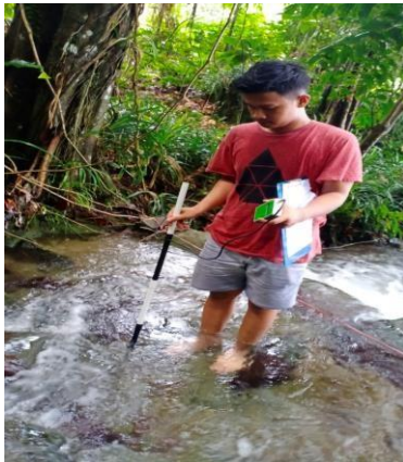
Gambar 16. Pengukuran Arus Menggunakan Current Meter
