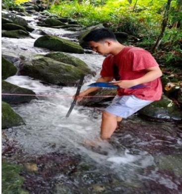
Gambar 15. Pengukuran Kedalaman Sungai D 1 sampai D 4
