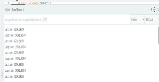
Gambar 12 hasil pengujian modul GY-GPS6MV2 Pada serial monitor untuk nilai latitude dan longitude
